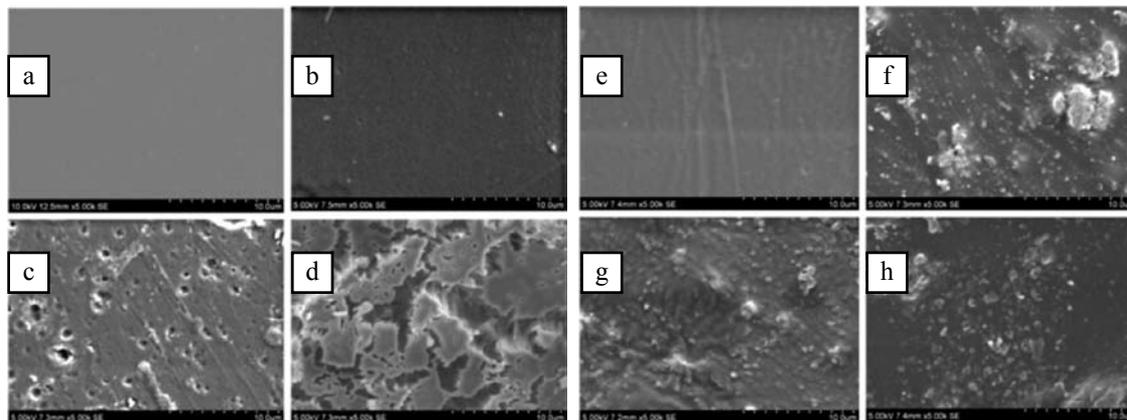
Fig. 1. SEM micrograph of PMMA a) Pristine b) 1×10<sup>11</sup> c) 5×10<sup>11</sup> d) 1×10<sup>12</sup> ions/cm<sup>2</sup> and PMMA – HAp e) Pristine f) 1×10<sup>11</sup> g) 5×10<sup>11</sup> h) 1×10<sup>12</sup> ions/cm<sup>2</sup>
