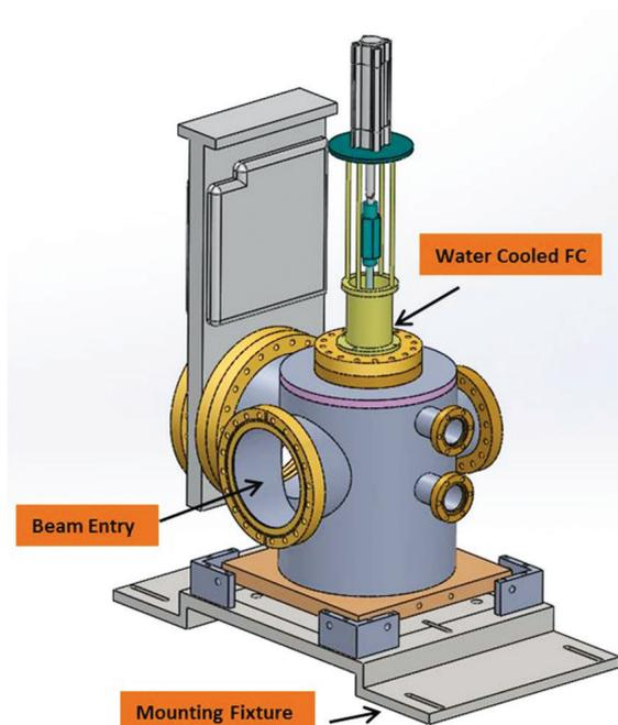
Fig. : 3.1.4: Pumping Chamber
