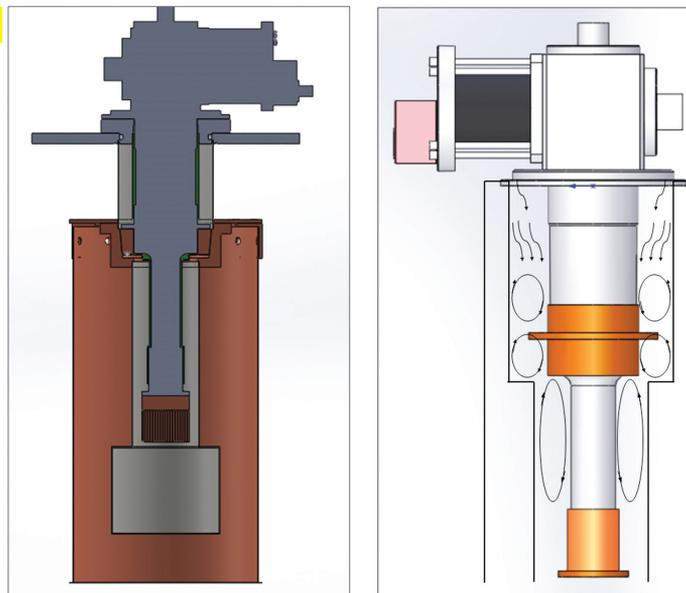
Fig. 3.1.11 : Liquefier cryostat with gas dynamics
