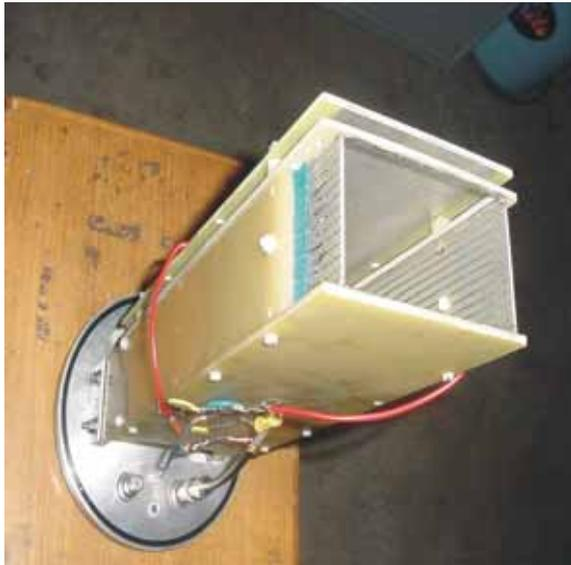
**Fig.6. IC electrode assembly**
