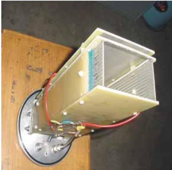
**Fig.6. IC electrode assembly**
